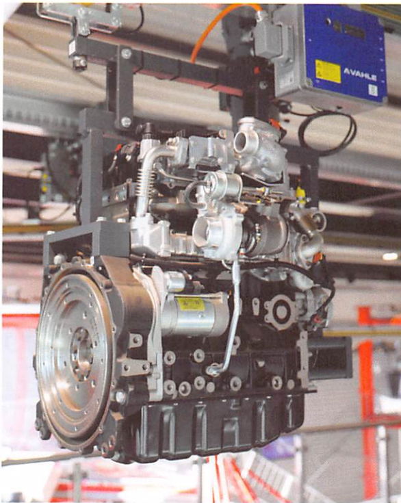
Nur 20 bis 25% Stromverbrauch einer klassischen EHB: Skyrail eignet sich in der Fahrzeugindustrie als Alternative zur C1-EHB.
