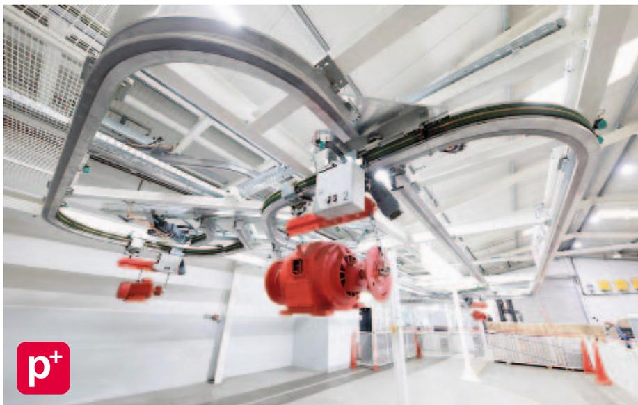
Maximale Leistung, minimaler Aufwand: Mit der neu entwickelten «Skyrail»-Elektrohängebahn wendet sich SEH vor allem an kleinere und mittlere Unternehmen. Foto: SEH
